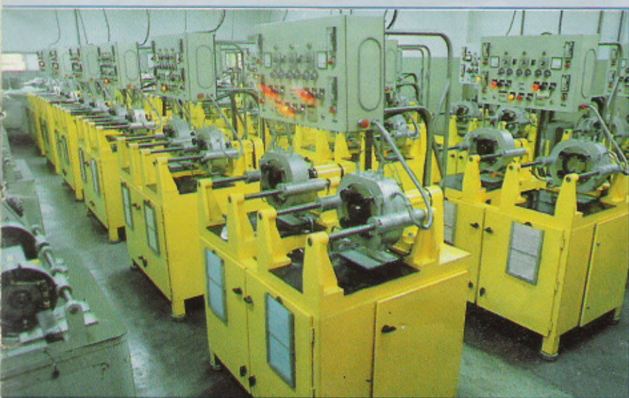
Equipamentos de testes de validação funcional e durabilidade do retentor.
