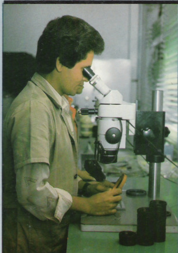
Controle de acabamento do Retentor.
